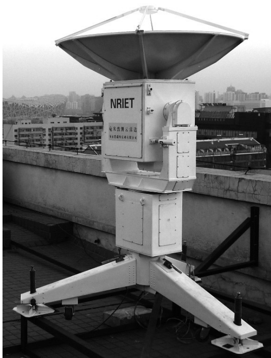
图1 中国科学院大气物理研究所Ka毫米波雷达 Fig. 1 The Ka band Doppler-radar at Institute of Atmospheric Physics, Chinese Academy of Science
